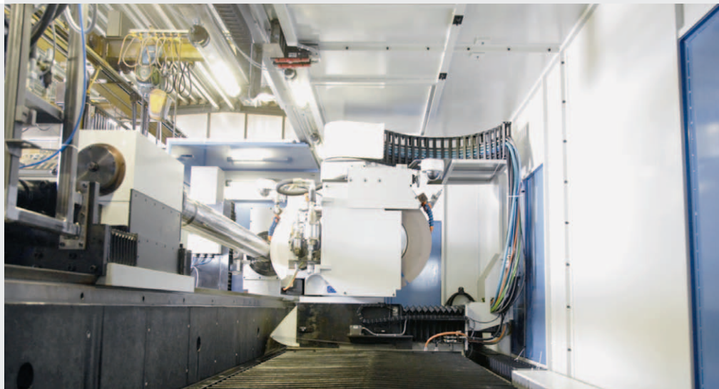
Absolutmesskopf mit Werkstück- Seitenansicht mit Schleifschlitten und 2x Aussen-Schleifscheibe
